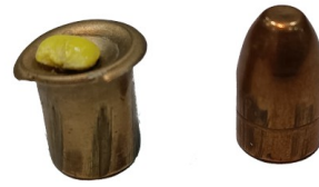
Links verschossenes Projektil der Action4, rechts normales Vollmantelgeschoss
