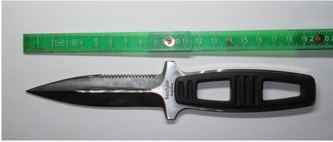
Beispiel für einen symmetrisch geschliffener Dolch
